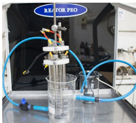
Figura 2 – Equipamento para tratamento por Oxidação por Plasma Eletrolítico (PEO) com reatores, sistema de controle de vazão e termopar (Autoria própria).
