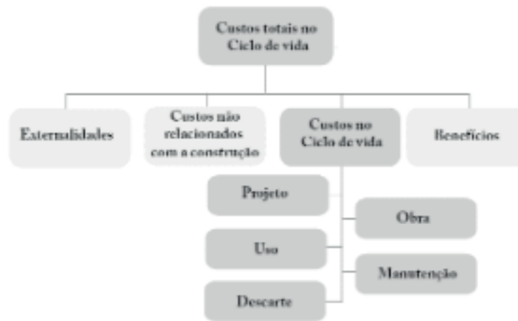
Figura 2. Identificação das etapas a considerar na análise do custo do ciclo de vida da edificação.
