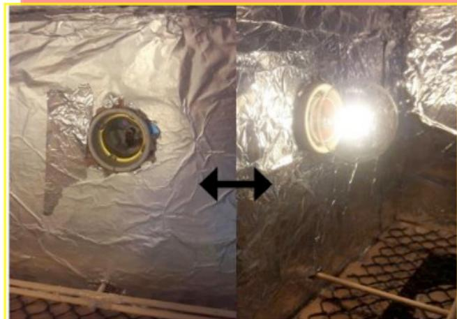
Figura 5: Furos laterais na caixa para instalação dos bocais e lâmpadas.
