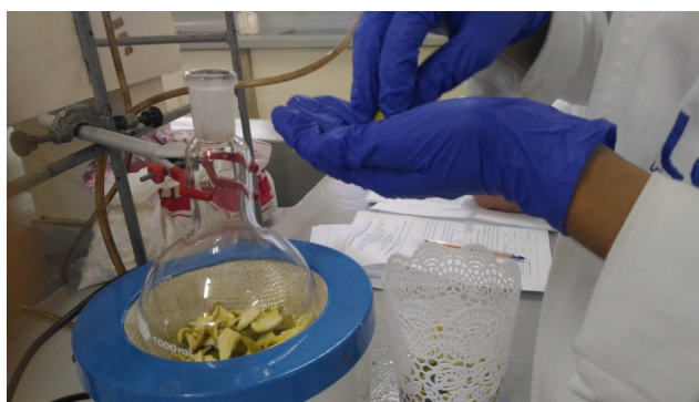
Figura 3: Preparação do substrato para destilação.
