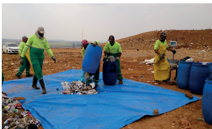
Figura 2 – Inserção dos resíduos pré-amostrados para quarteamento.
