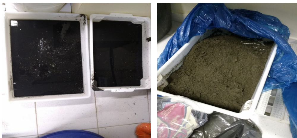
Figura 2: Lodo antes (a) e após a secagem natural (b)
