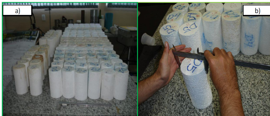
Figura 6. Corpos de prova para ensaio de compressão: (a) organização dos grupos, (b) utilização de paquímetro.
