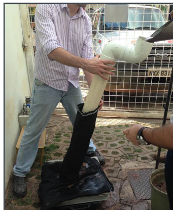
Figura 11. Preenchimento do Tubo de Geotêxtil.
