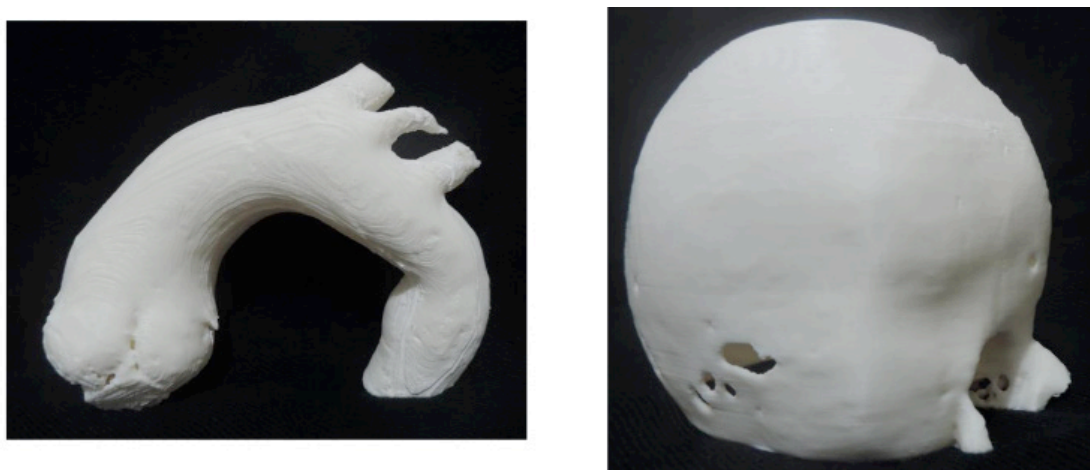
Figura 2: Aspecto final das peças impressas em ABS
