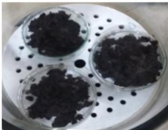
Figura 3. Placas com material para análise de umidade
