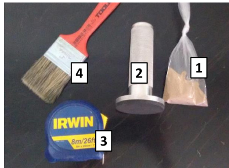
Figura 4- Materiais do ensaio da mancha de areia
