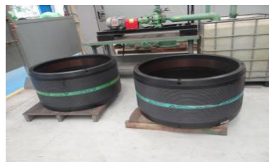
Figura 7: Luvas de Eletrofusão
