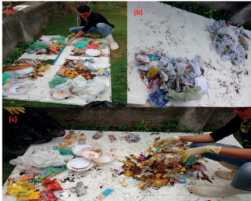
Figura 2. (a) Técnica de quarteamento dos resíduos sólidos, (b) Escolha dos dois quadrantes em lados opostos entre si, (c) Separação dos resíduos por cada tipo.
