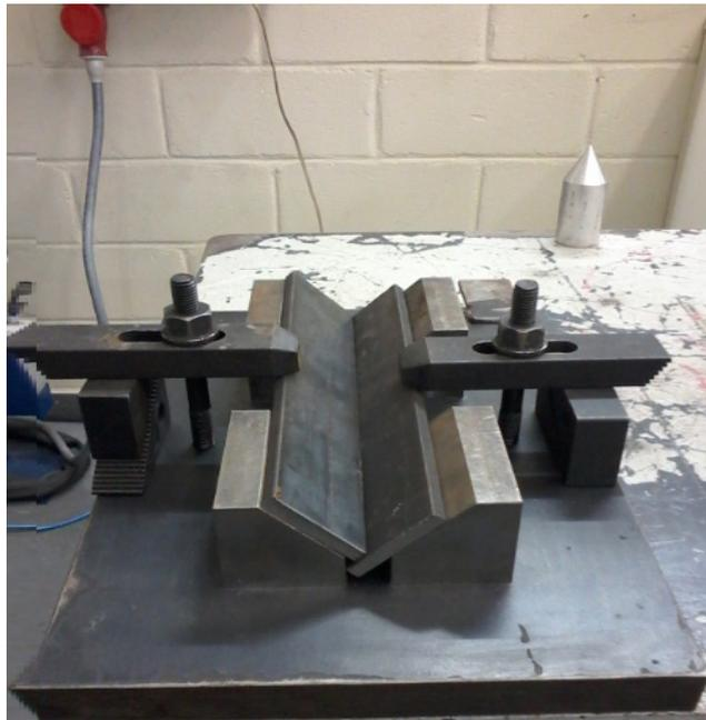
Figura 1 – Fixação e montagem do corpo de prova no dispositivo de solda
