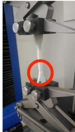
Figura 09: corpo de prova com detalhe no rompimento.
