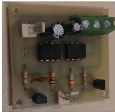
Figura 10 – PCB desenvolvida para tratar os sinais gerados pelos canais do encoder óptico.
