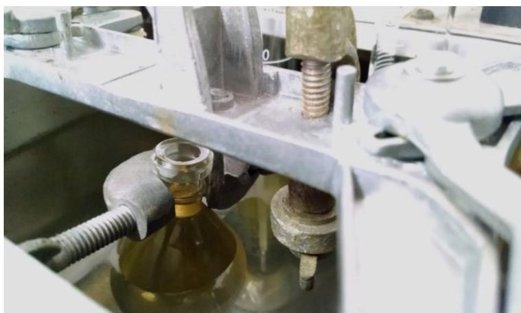
Figura 4: Resfriamento do picnômetro
