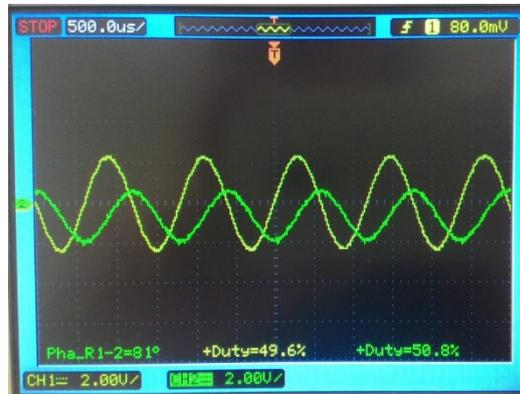
Figura 12 – Sinais analógicos dos canais A (amarelo) e B (verde) do encoder óptico. Tais sinais estão defasados entre si por um ângulo de  $81^\circ$  devido ao deslocamento no sentido positivo (para à direita) da mesa cartesiana.
