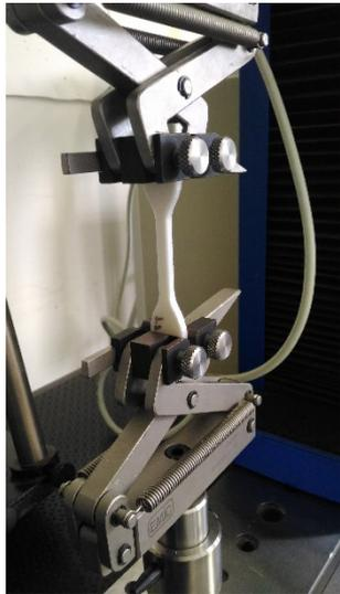
Figura 08: corpo de prova durante realização do ensaio.
