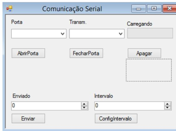
Figura 6 – Interface do programa aplicado no controle do foco, do LED UV e do processo de gravação do equipamento de litografia óptica.
