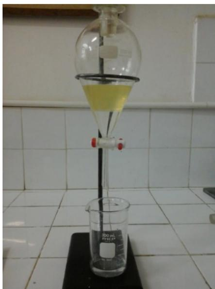
Figura 3: Processo de lavagem do biodiesel
