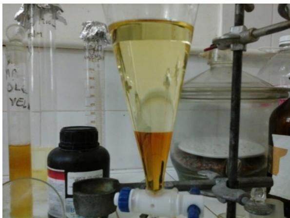
Figura 2: Processo de separação biodiesel e glicerina
