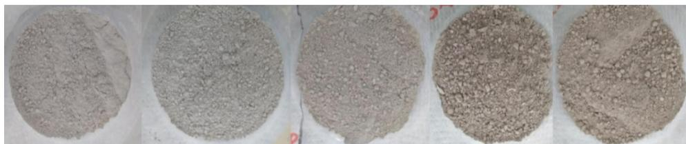
Figura 4 –  $\text{TiO}_2$  após 1, 2, 3, 4 e 5 h de moagem (da esquerda para direita).
