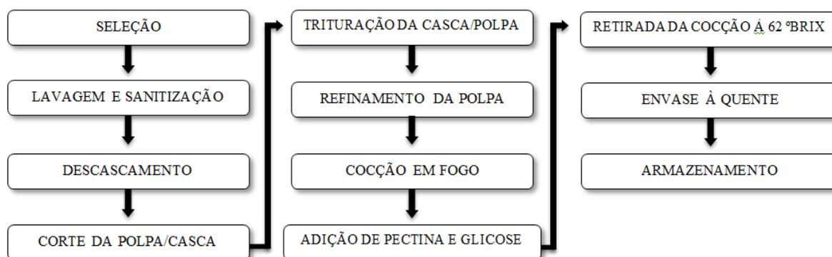
Figura 1 – Fluxograma do processamento de geleia de abacaxi.
