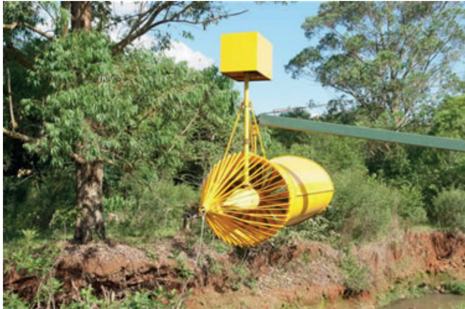
Figura 6: Modelo de balsa com turbina axial totalmente imersa na água.
