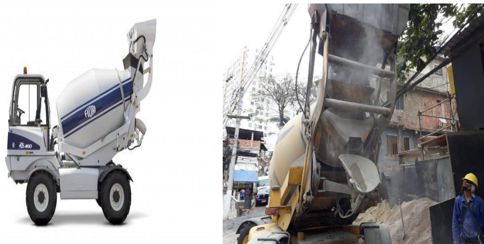
Figura 6: Caminhão betoneira DB460 - FIORI. Fonte: FIORI GROUP / Caminhão betoneira da obra.
