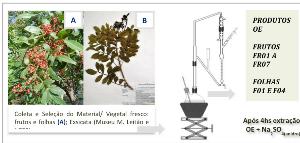
Figura 1- Obtenção do Óleo Essencial a partir de folhas e frutos da Aroeira ( S. terebinthifolia ) por hidroddestilação (aparelho de Clevenger).
