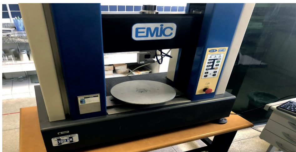
Figura 3 – Máquina universal de ensaios mecânicos destrutivos (EMIC®, Modelo DL 10000) localizado no Laboratório de Ensaios de Materiais da Universidade Federal do Vale do São Francisco (UNIVASF), Campus Juazeiro – Juazeiro, 2018.
