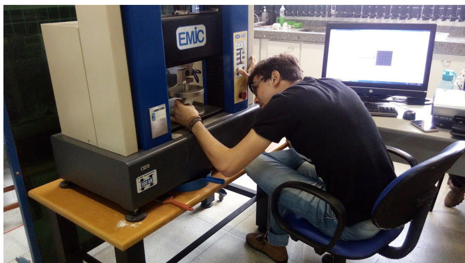
Figura 2 – Posicionamento da valve na placa de compressão, realizando ensaio em máquina universal de ensaios mecânicos destrutivos (EMIC®, Modelo DL 10000) localizado no Laboratório de Ensaio de Materiais da Universidade Federal do Vale do São Francisco (UNIVASF), Campus Juazeiro – Juazeiro , 2018.
