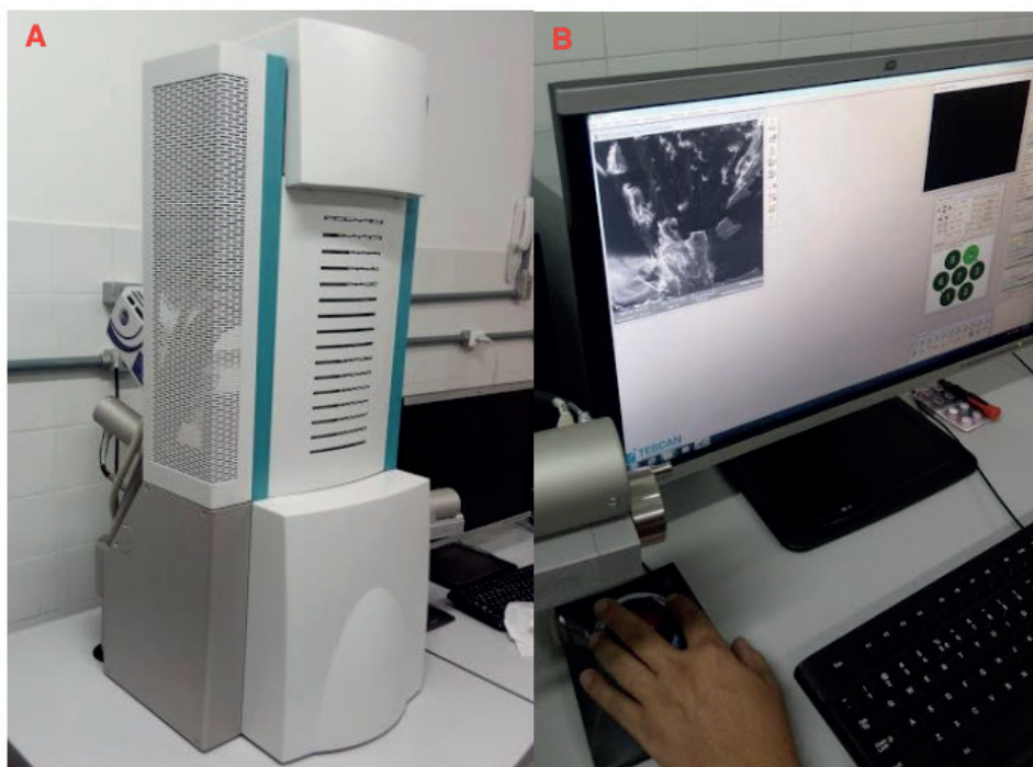
Figura 4 – a) Microscópio eletrônica de varredura (TESCAN®), b) análise da superfície em tempo real através do programa VEGA3® – Juazeiro, 2018.
