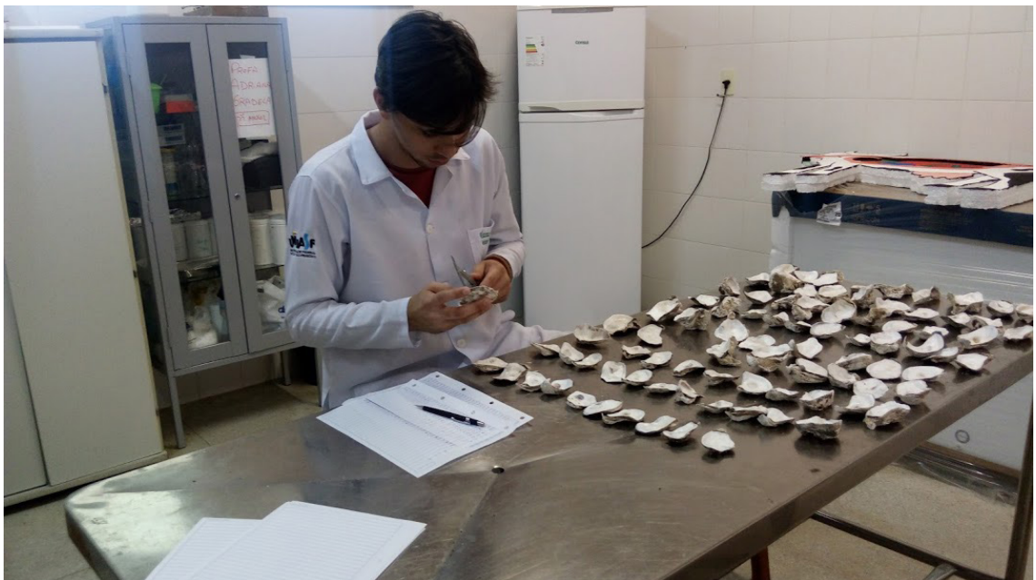
Figura 2 – Determinação biométrica, mensurando comprimento, largura e espessura das conchas ( Crassostrea gigas ), utilizando paquímetro de aproximação milimétrica – Petrolina (PE), 2018.
