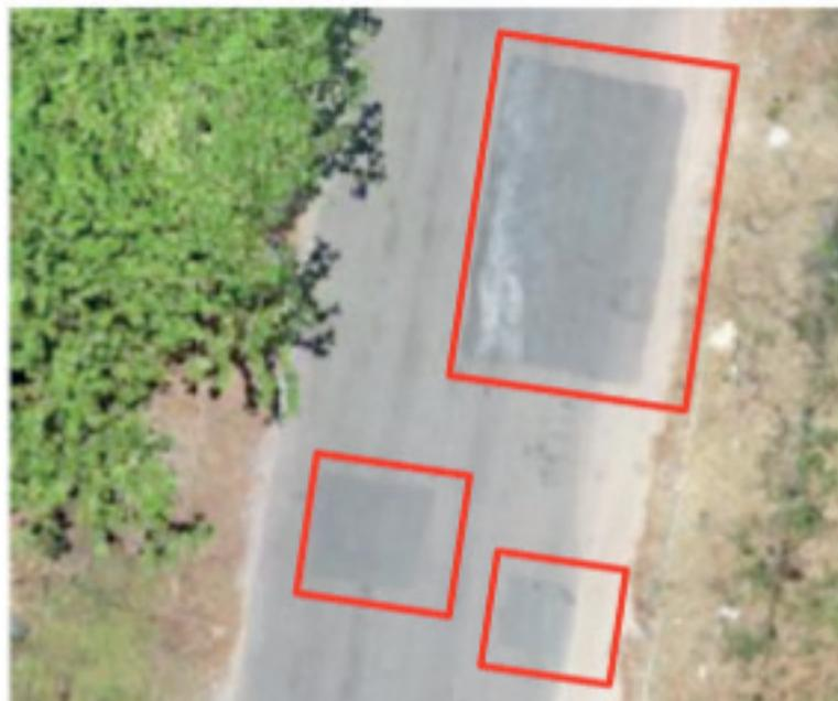
Figura 4. Regiões com remendo visualizadas no mosaico.
