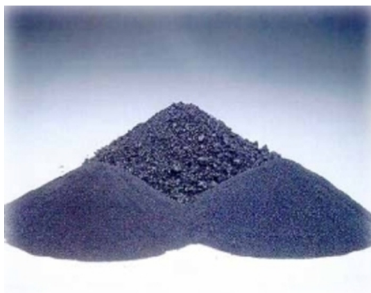
Figura 2 – Carbeto de boro na forma pulverulenta (TURATTI, 2009).
