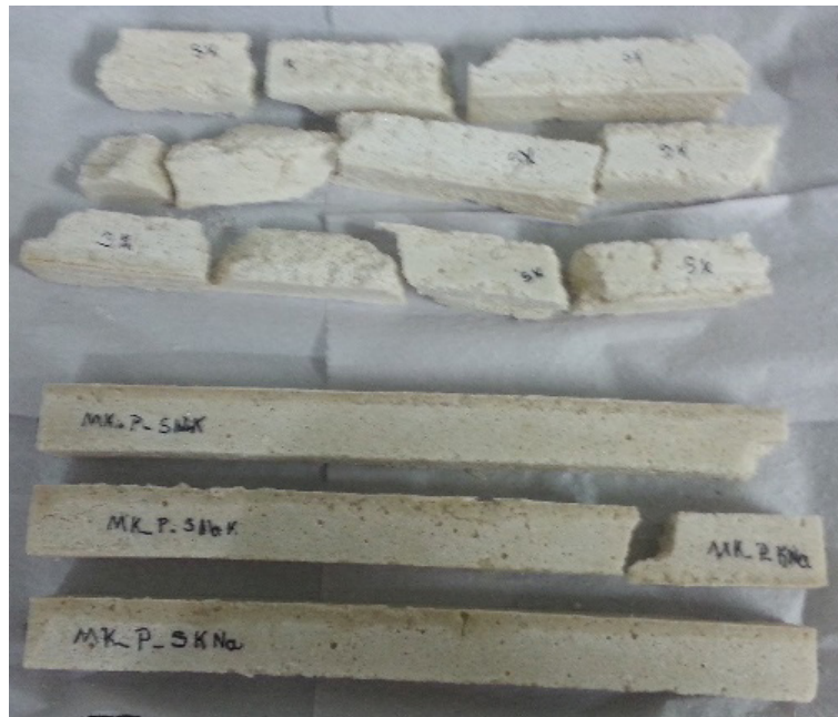
Figura 11: Barras de MK.P.SK (metacaulinita, pirex e silicato de potássio) e de MK.P.SKNa (metacaulinita, pirex e silicato de potássio+silicato de sódio).
