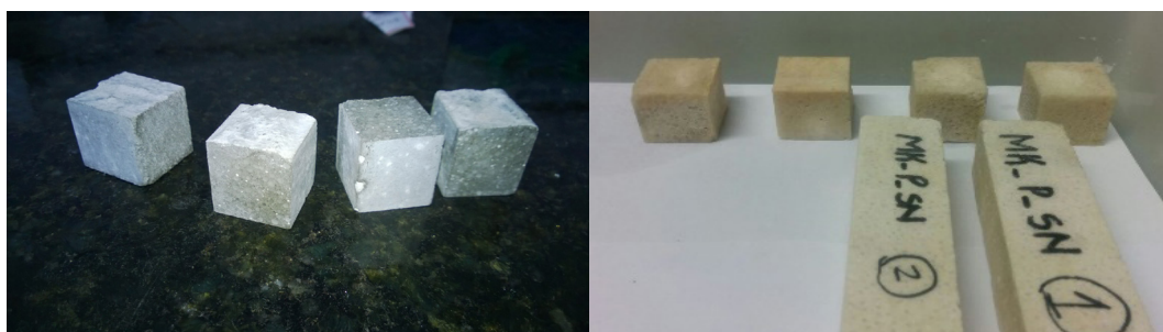
Figura 15: Cubos utilizados nos testes de resistência a compressão.
