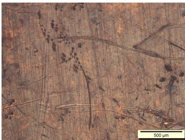
Figura 3 – Amostra de cobre sem tratamento superficial. Ampliação 50x.
