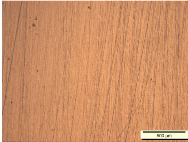
Figura 4 – Amostra de cobre após lixamento em lixa d’água na sequência 200, 320, 420, 600, 800, 1000 e 1200. Micrografia após a lixa 1200. Ampliação 50x.
