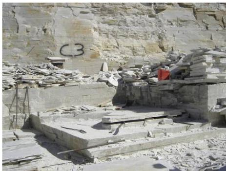
Figura 2: Extração das placas de quartzito
