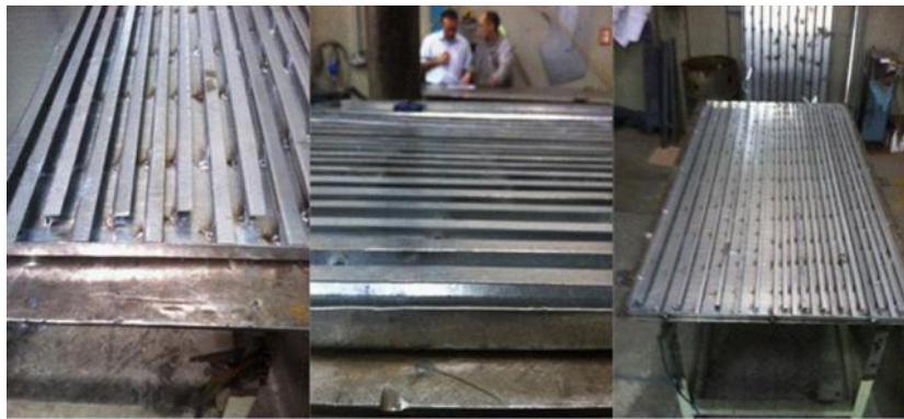
Figura 7 - Dutos fixados na chapa (SILVA et al., 2018b).
