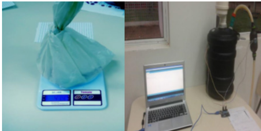
Figura 3: a) Pesagem dos resíduos sólidos orgânicos recolhidos no campus. b) Biodigestor utilizado para a produção do gás Metano.
