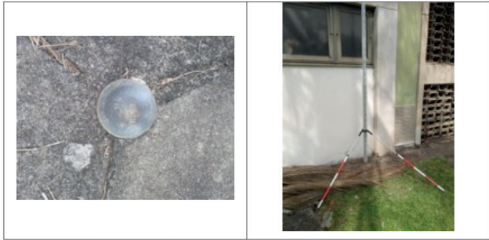
Fig.05 – Posicionamento da mira sobre a RN no IGC
