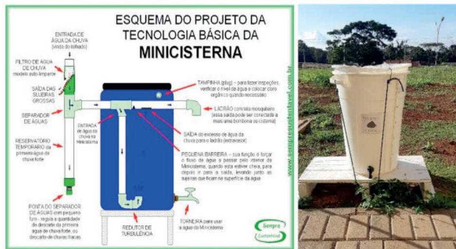
Figura 10 - Modelo de minicisterna a serem adotados no Câmpus. Protótipo instalado para coleta de águas pluviais.
