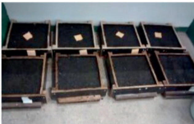
Figura 3 - Placa de asfalto
