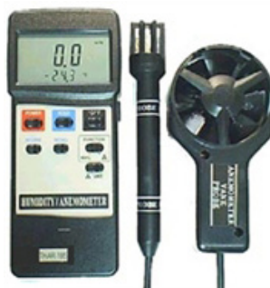
Fig. 3 Termo-higro-anemômetro digital portátil
