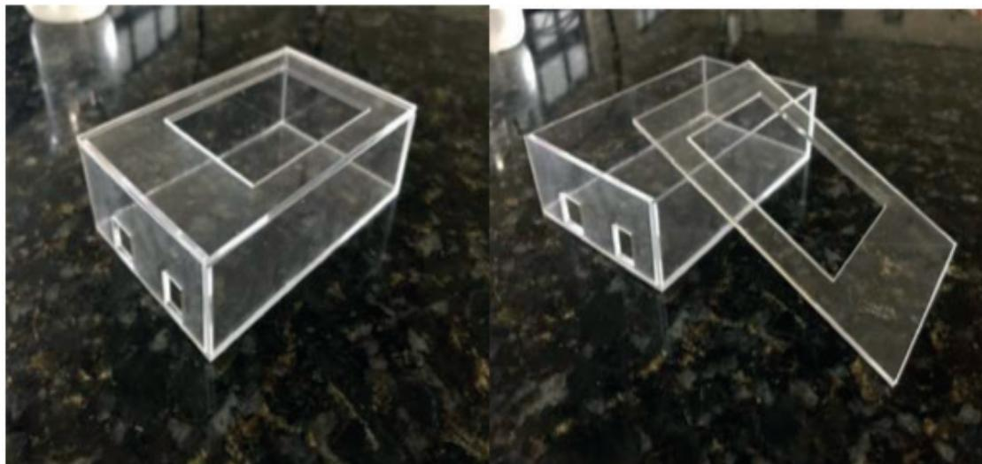
Figura 6. Caixa Estanque do Termômetro
