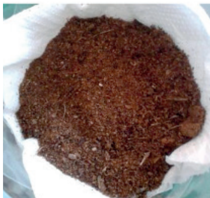
Figura 1. Farinha das cascas de diferentes tipos de bananas secas e processadas, usadas para estudos de absorção de azul de metileno.
