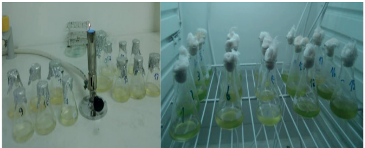
Figura 5A e 5B – Amostras a serem analisadas, 5 réplicas de controlo e 3 para cada uma das amostras da substância, enumeradas, na câmara estufa, à 22°C, iluminada.
