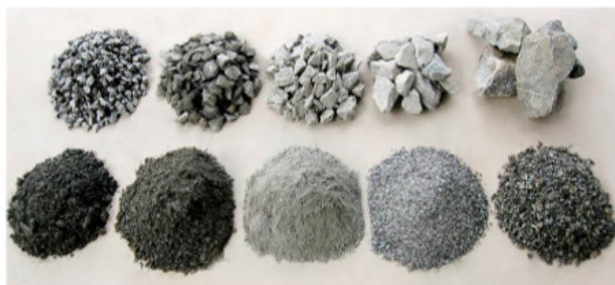
Figura 1 – Tipos de Britas com diferentes granulometrias.
