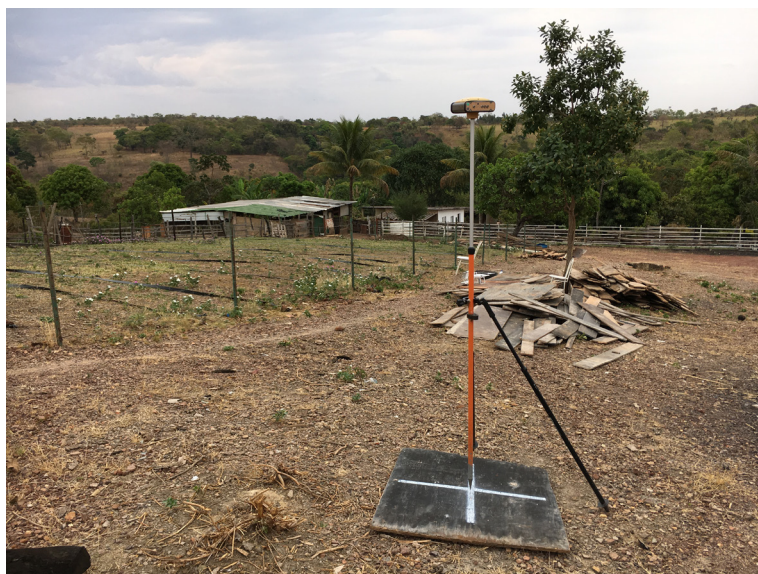
Figura 2 - Implantação de pontos de controle. Fonte: Autor (2018).
