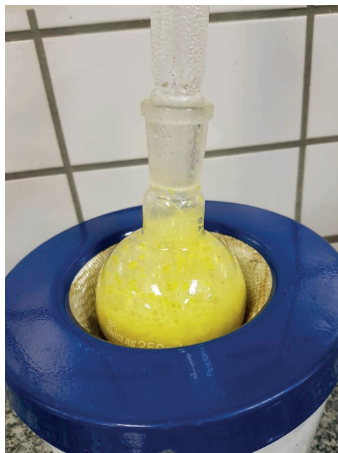
Imagem 2: Extração do óleo essencial da casca da laranja em uma manta aquecedora
