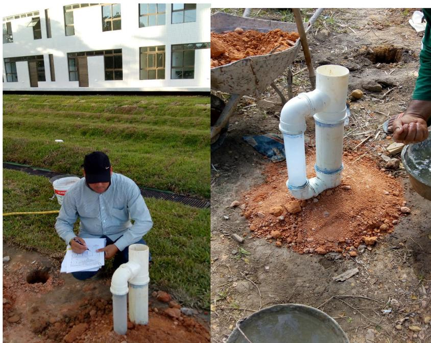
Figura 16 - Ensaio de permeabilidade com carga variável
