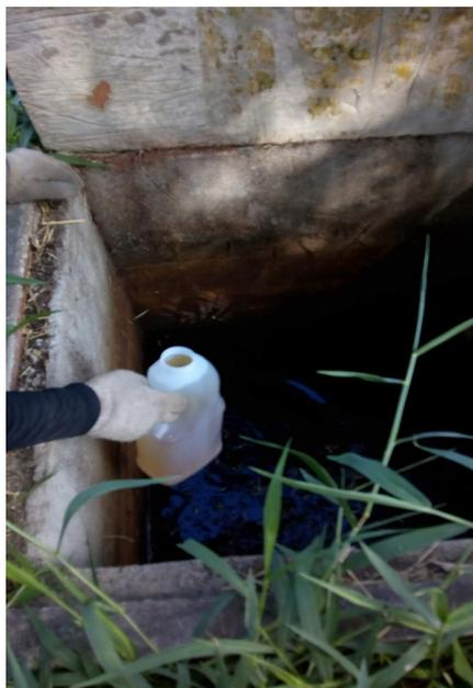
Figura 26 - Coleta da amostra de esgoto tratado do sistema em operação do IFPE.
