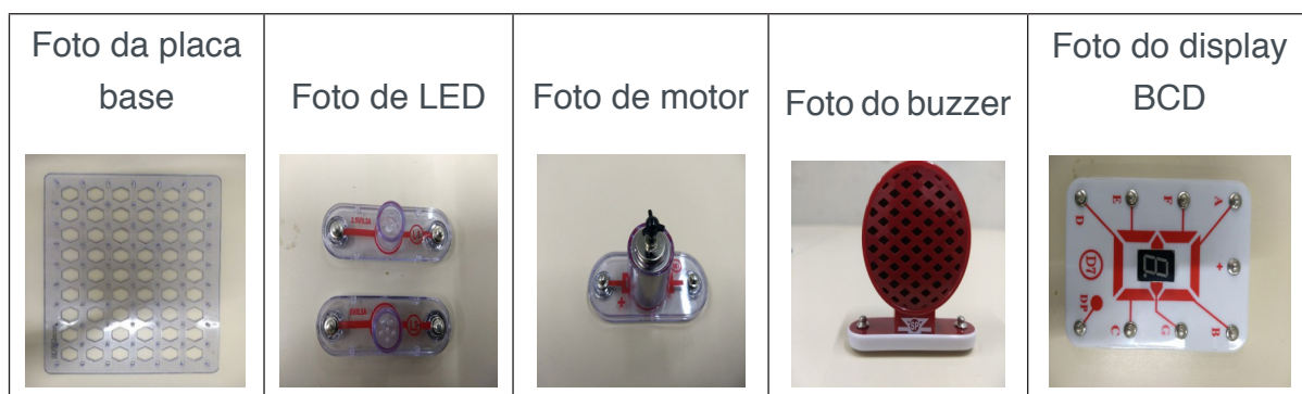
Figura 1 – Imagens dos componentes do kit Snap Circuits ®
