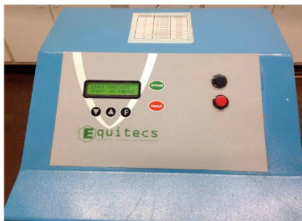
Figura 2. Painel de controle da máquina de ensaios de cisalhamento direto.
