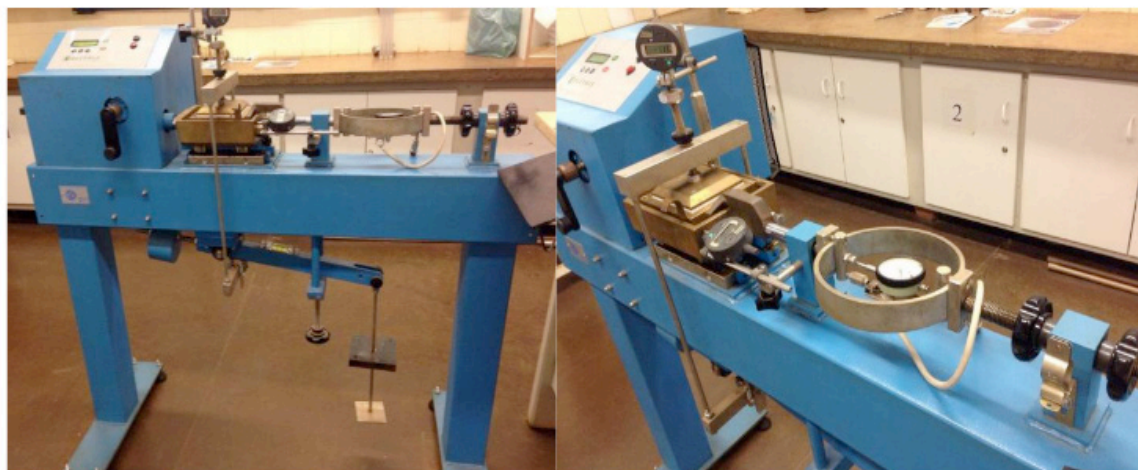
Figura 1. Equipamento utilizado para os ensaios de cisalhamento direto.
