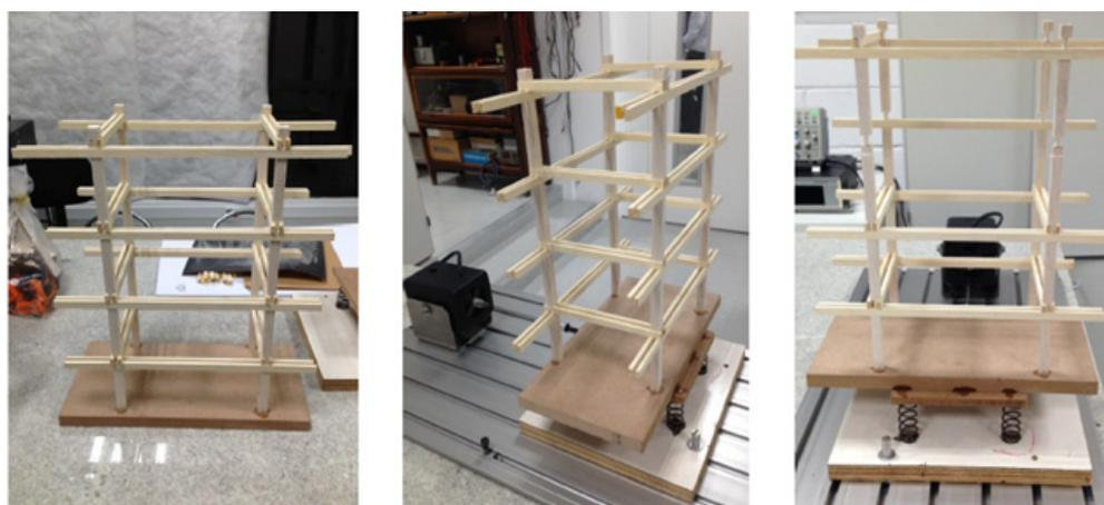
Figura 8: Aspectos do modelo físico antes as vibrações e o modelo com pontos colapsados entre o 2o pavimento e o pavimento de cobertura.
