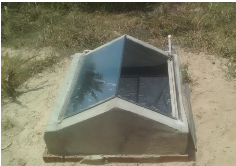
Figura 3- Estrutura com lona instalada na base.
