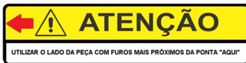
Figura 9 - Adesivo para instrução de montagem da peça no *Poka Yoke*
