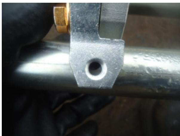
Figura 4 - Peça com a furação deslocada
