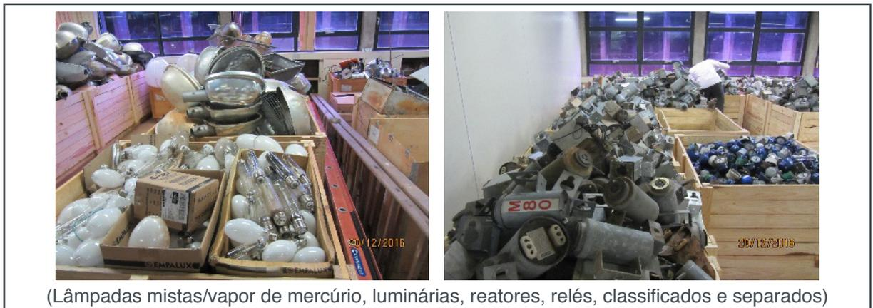
Figura 6 – Componentes do sistema de iluminação ao fim da vida útil, retirados de campo.
