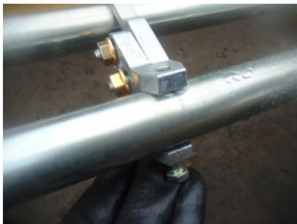
Figura 3 - Processo de inspeção com parafuso e a contra peça
