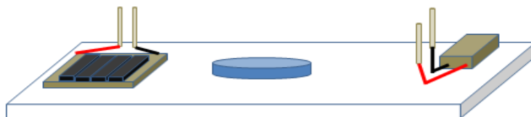
Figura 20. Fixando os Terminais do Adaptador P4 e do Suporte de Pilhas.
