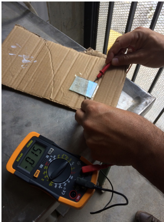
Figura 11. Placa de açaí gerando 15 mV.
