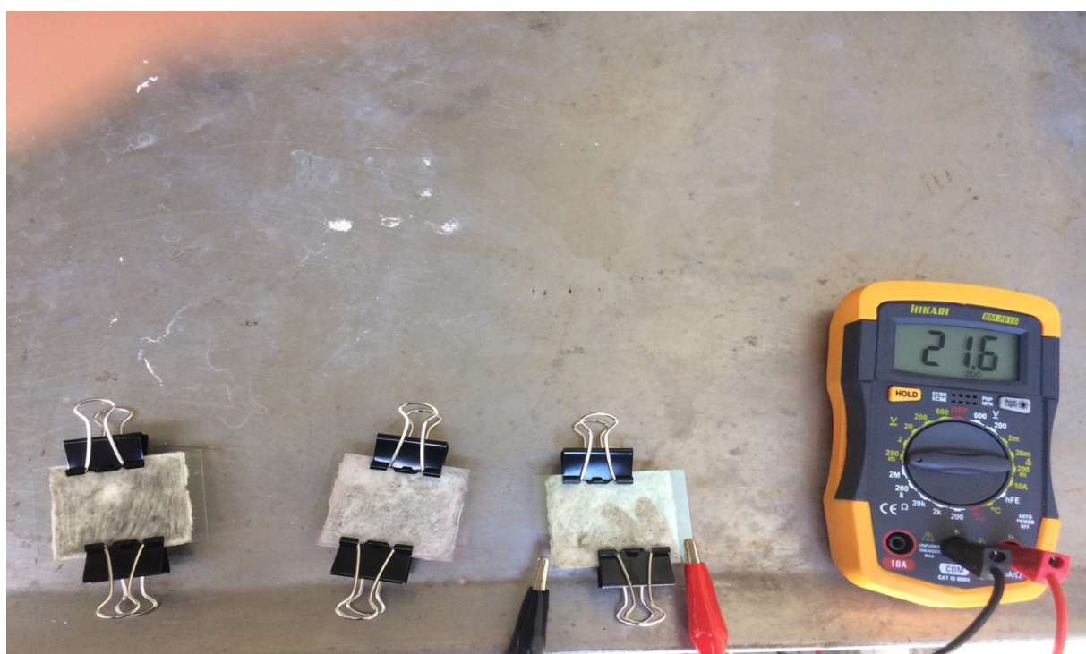
Figura 17. Célula clorofila gerando 21,6 mV.
