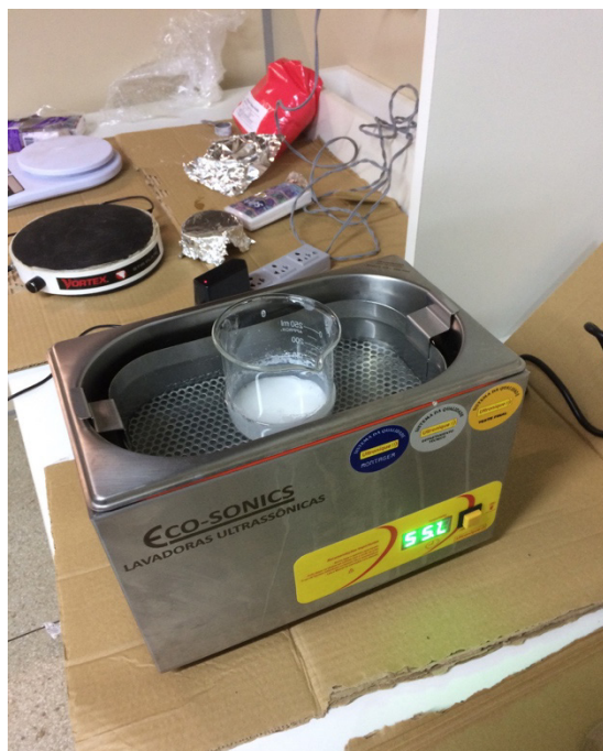
Figura 3. Ultrassom com a solução de \text{TiO}_2 .
