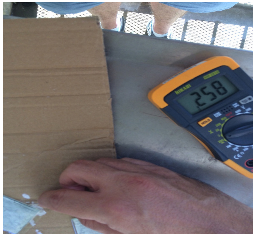
Figura 14. Célula de clorofila gerando 258 mV, sem estabilidade na medição.
