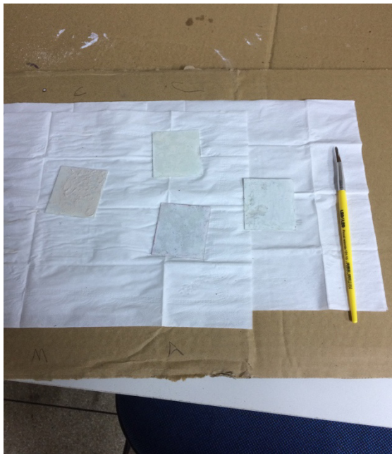
Figura 7. Deposição do eletrólito nas placas. Figura 8. Grafite 6B pronto para ser depositado.
