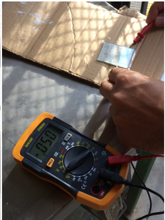
Figura 12. Célula de açaí gerando 50 mV.
