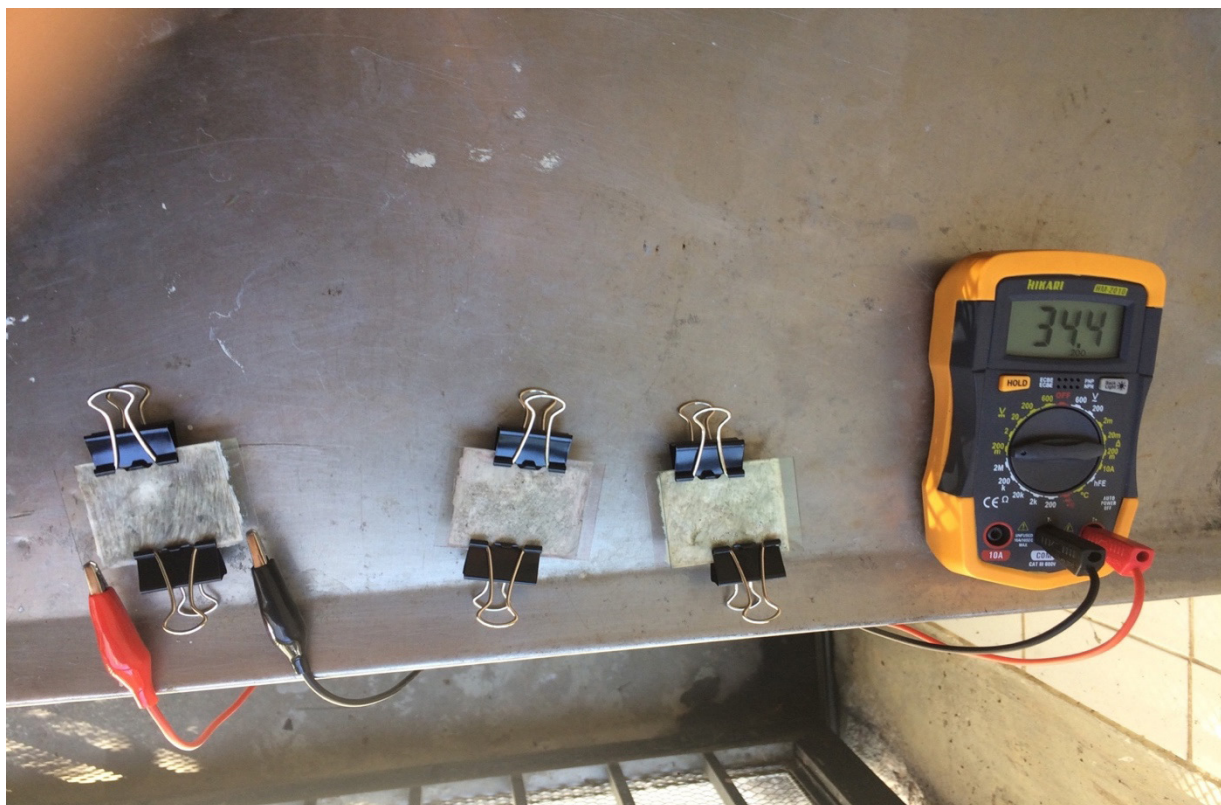
Figura 16. Célula de açaí + clorofila gerando 34,4 mV.
