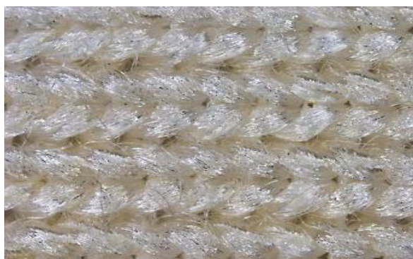
Figura 5: Estrutura do material têxtil composto por Polipropileno com Bambu (PP+BAM).
