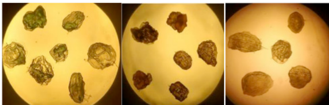
Figura 1. Micrografia óptica das microesferas (a) puras, (b) dopadas com níquel e (c) dopadas com ferro.
