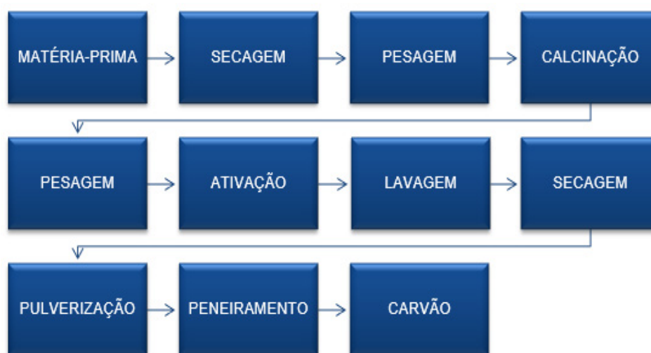
Figura 4- Fluxograma do processo de Produção do carvão ativado
