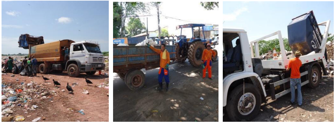
Figura 01: Veículos para coleta de RSU em Castanhal: compactador, carroça com trator, poli guindaste com caixa Brooks (esquerda à direita.).
