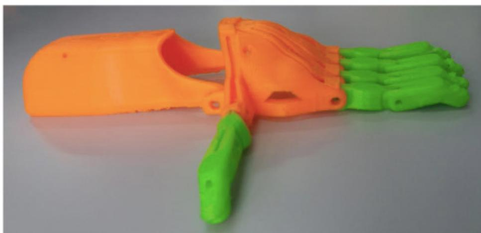
Figura 4: Prótese Cyborg Beast para amputação transcarpal, impressa com o uso da impressora 3D da marca Cliever, modelo CL1 Black Edition.
