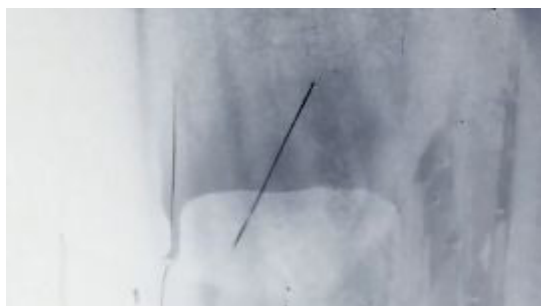
Figura 4 - Próton observado na câmara de nuvens.
