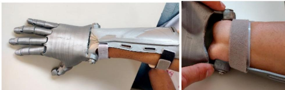
Fig.11 – Primeiro teste de ajuste da prótese com a voluntária
