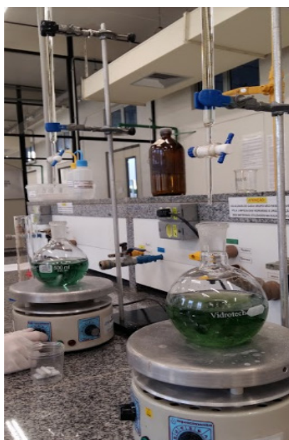
Figura 2 – Titulação para determinação da DQO
