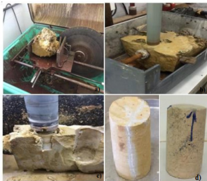
Figura 1. Preparação das amostras e extração dos plugues para os ensaios. a) Corte das amostras, b, c, extração de plugue com mandril e serra copo, e d) plugs extraídos
