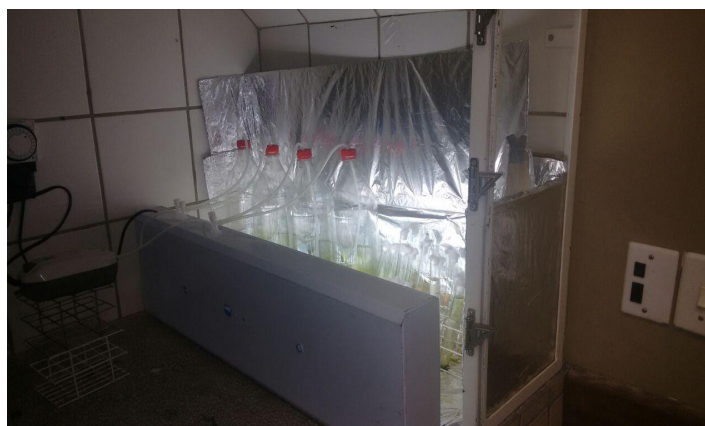
Figura 3: Capela de exaustão revestida com papel alumínio e iluminação artificial.
