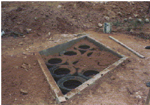
Figura 7. Cava executada para ensaio de densidade in situ (Sieira, 1998)
