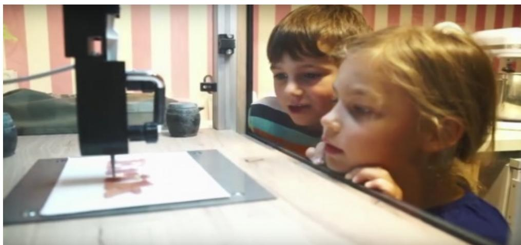
Figura 1: Doce sendo fabricado por Manufatura Aditiva em uma doceria de Miami.
