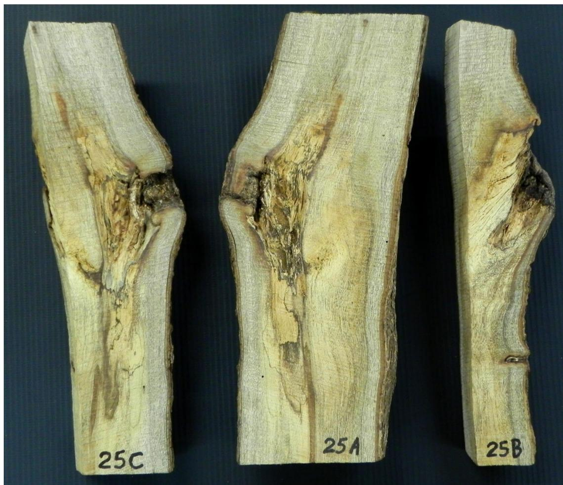
Figura 6 – Peça nº 25 (canforeira), seccionada para expor necrose no interior do lenho.
