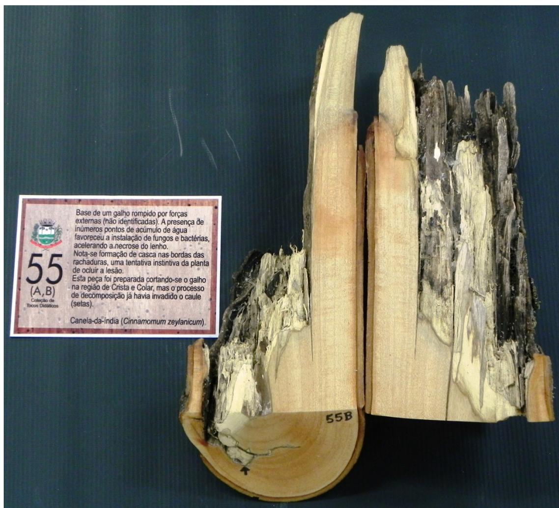
Figura 7 – Peça nº 55 (canela-da-índia) seccionada longitudinalmente para expor necrose.
