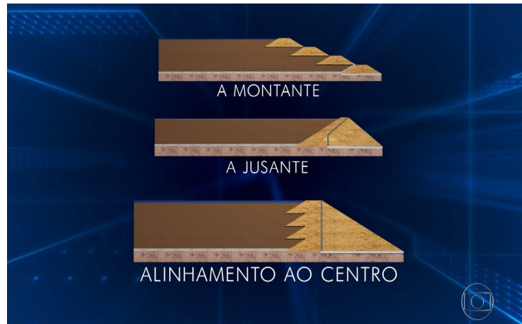
Figura 2 – Classificação das barragens de contenção de rejeitos. Duarte, A. P.(2008).
