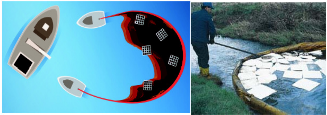
Figura 1: Uma barreira de não tecido rebocada por barcos cerca o óleo.
