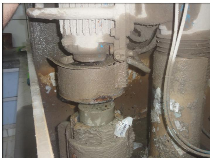
Figura 4: Retificação dos corpos de prova.
