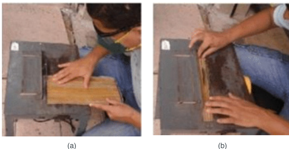
Figura 12 – (a), (b) Execução do corte dos corpos de prova de acordo com a norma ASTM 3039.
