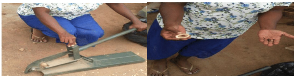
Figura03: Quebra do Baru e extração da amêndoa por equipamento destinado à essa finalidade.
